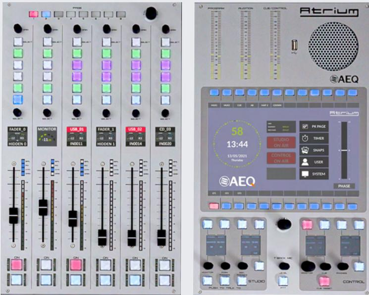
Los canales tienen vúmetros individuales, faders motorizados de 100 mm, pantalla a color y 8 teclas programables. Como opción, se puede añadir una pantalla táctil por cada módulo de 6 canales. En esa pantalla se representan los vúmetros y se ajustan los procesos. Cada módulo maneja 8 páginas o capas de configuración.
