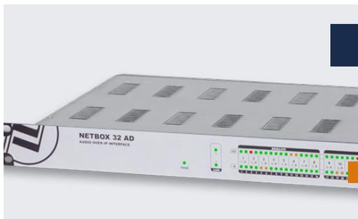
Conecta la red de audio por IP a 32 canales de entrada y 32 de salida, repartidos en 16 analógicos mono y 8 digitales estéreo. Los digitales estéreo pueden configurarse como AES/EBU ó SPDIF. Además incorpora 16 GPI y 16 GPO.
