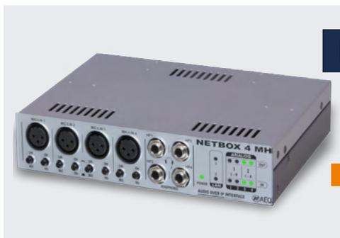
Permite la conexión a la red de audio por IP a 4 canales de entrada para micrófono o línea analógica y 4 canales de salida, para auricular estéreo y línea analógica. Incorpora 4 GPI y 4 GPO. Dispone de GPIOs adicionales para terminales de señalización como Studiobox. Puede alimentarse por PoE.
