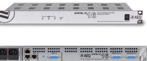
De 1 UR para 16 líneas telefónicas IP simultáneas, 4 líneas adicionales para teléfonos IP de operador, 4 entradas/salidas digitales, 2 entradas/salidas analógicas y 32 entradas/salidas IP protocolo Dante™-AES67, suficiente para un sistema de coordinación de televisión multiestudio.
