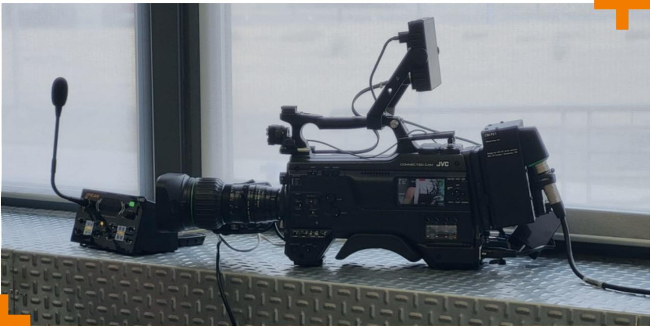
Para llevar a cabo la prueba se conectó CM-FK1 CAM a la cámara y a un beltpack Xpeak\_BP. Se conectó CM-FK1 STD al controlador remoto RM-LP25 y a un panel de intercom de rack Xpeak\_R. La doble conectividad IP de cada uno de los terminales CM-FK1 permite la conexión directa de los paneles, que dada su condición de peer to peer, se reconocieron y trabajaron sin más configuración. La conectividad de la cámara con el controlador no se vio afectada.
