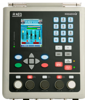
Detalle superficie de control conexión establecida y vúmetros en pantalla
