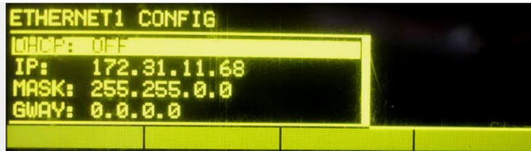
Detalle configuración dirección IP en AEQ Phoenix Studio
