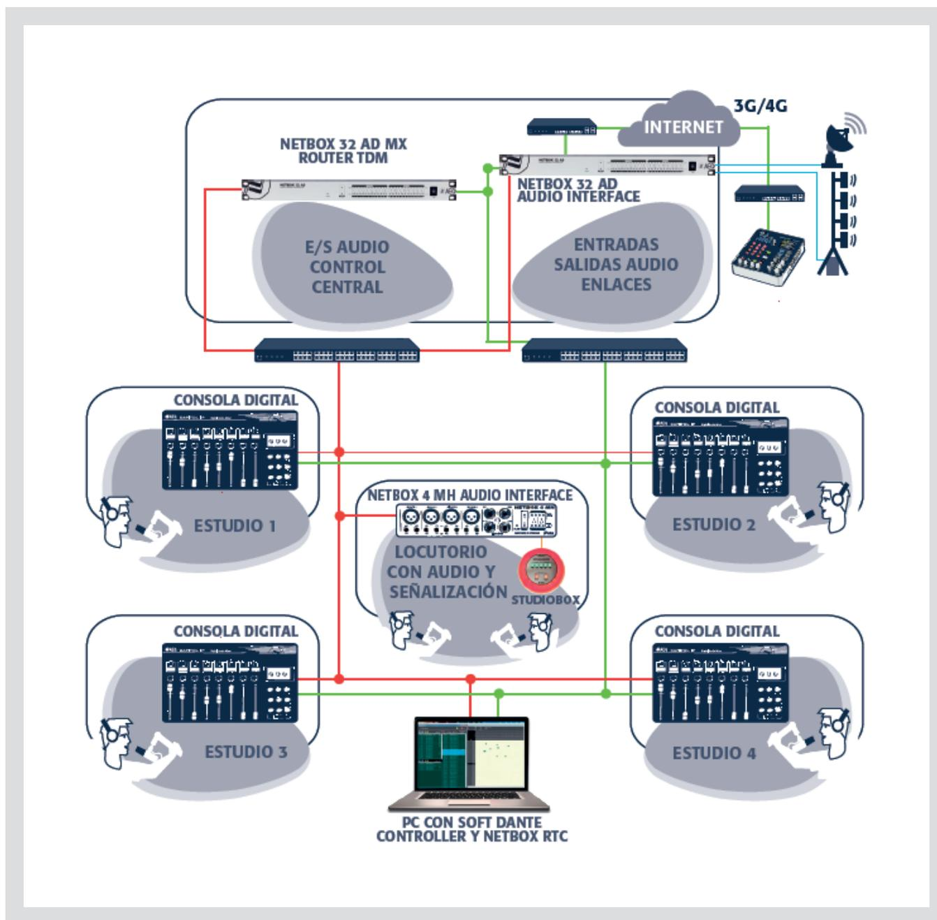
El esquema representa la instalación de una estación de radio de cuatro estudios.
