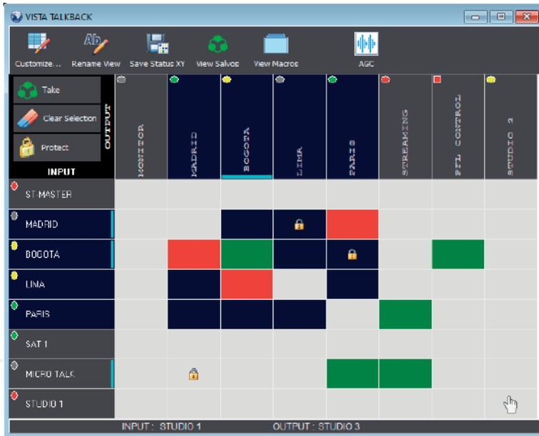
La ventana XY muestra las entradas a la izquierda, en filas, las salidas arriba, en columnas. Junto al nombre de cada entrada o salida hay un indicador de nivel de cuatro colores, diferenciado para las salidas no sumables y un indicador de AGC activado.
