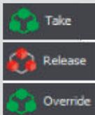
El botón "Take" activará el salvo realizando las conexiones / desconexiones y / o protección / desprotección de puntos.
